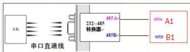
控制器的接线端 11、12 脚通过 485 转换器连接到电脑串口后，打开设参软件选择好对应的串口，点击[查找设备]按钮，左下角显示正在查找设备，IC 卡控制器上电，待找到设备后(即[显示设备版本号])，此时方可进行一下设参。
