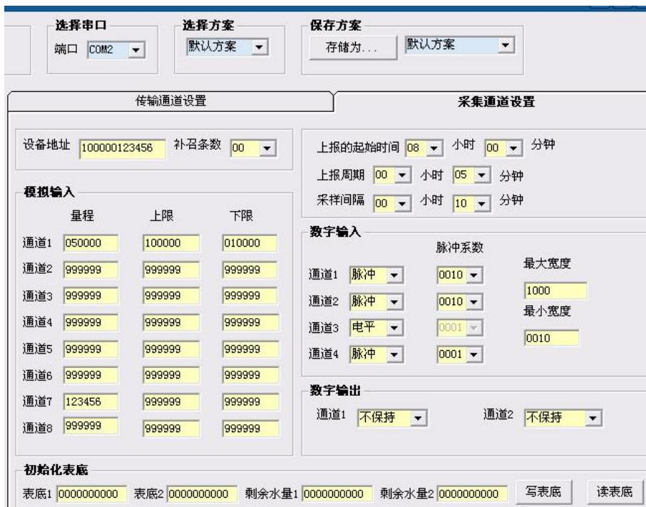
仪表与上位机连接方法：与上位机通信需要用 485 转 232 转换器与电脑串口相连。
