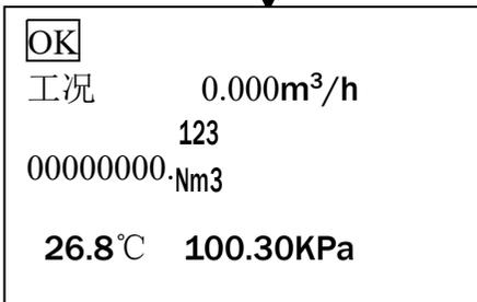
显示工况瞬时流量(m<sup>3</sup>/h),标况累积总量(Nm<sup>3</sup>),介质温度(℃)和压力(KPa)。
