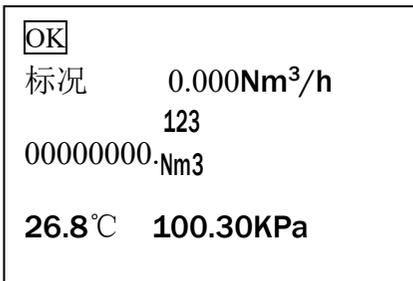
显示标况瞬时流量(Nm<sup>3</sup>/h),标况累积总量(Nm<sup>3</sup>),介质温度(℃)和压力(KPa)。
