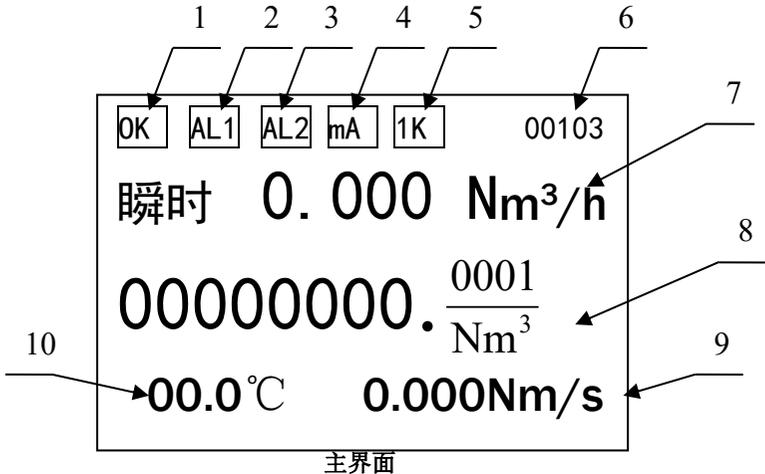
标签 1: 仪表运行状态实时显示, 如果正常显示“OK”, 故障显示“ERR”
