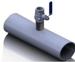
图 8 球阀安装后的效果图
