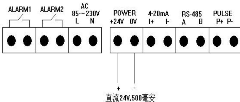
(2) 四线制 4-20mA 电流输出和 HART 手操器的接法:
